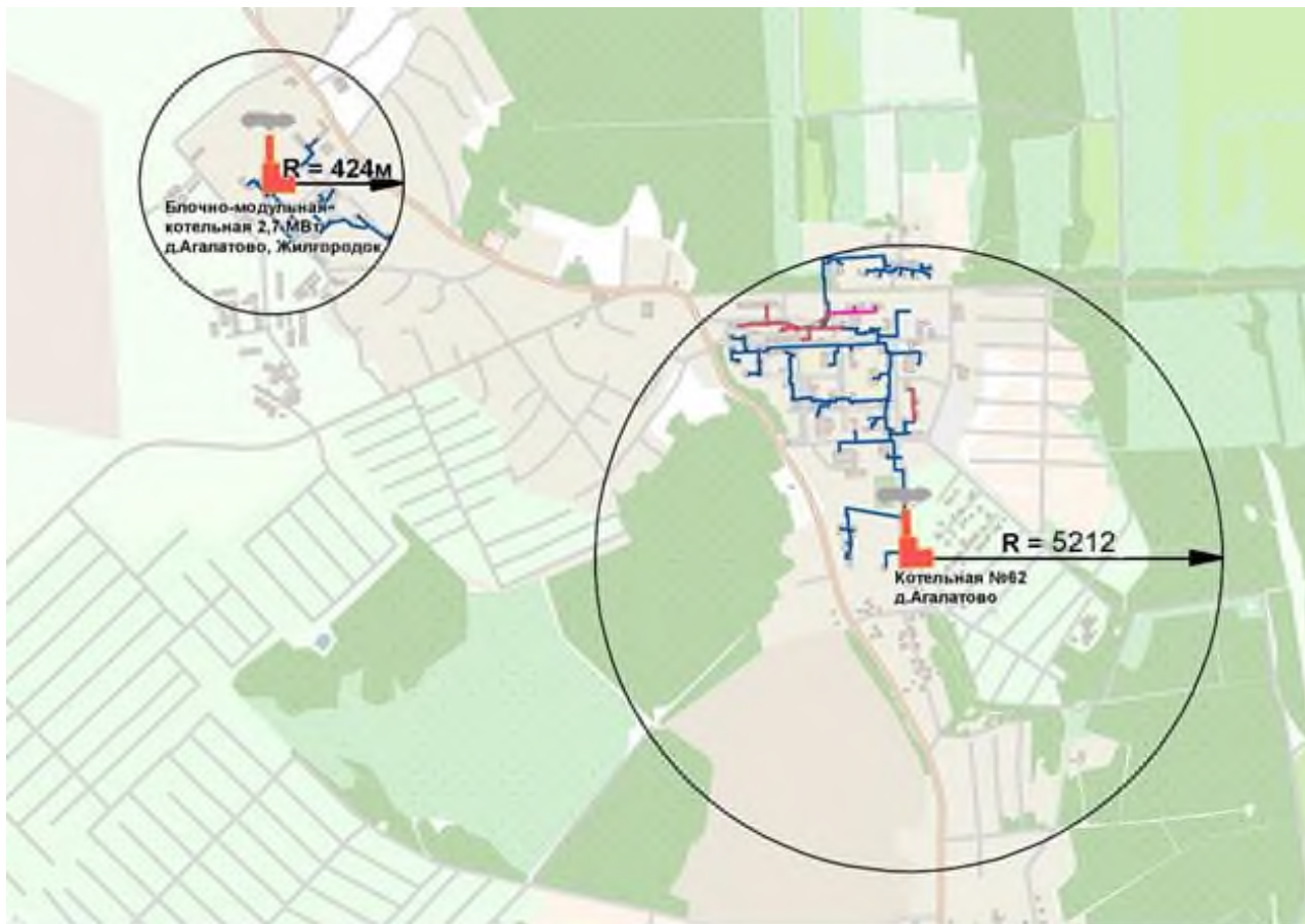
Рисунок 21. Радиус эффективного теплоснабжения от источника т/эн д.Агалатово
